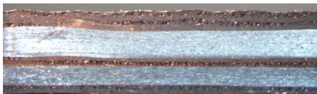
Obrázek 35: Zvlněné vrstvy různých orientací vláken pozorovaných v obrobené ploše
