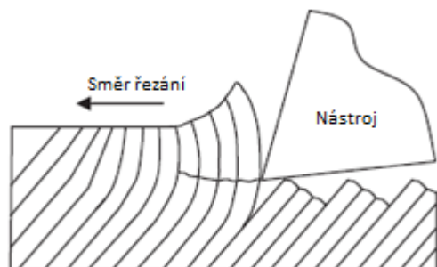
Obrázek 10: Mechanismus vzniku třísky při \theta = 135^\circ a \beta = 45^\circ [3]
