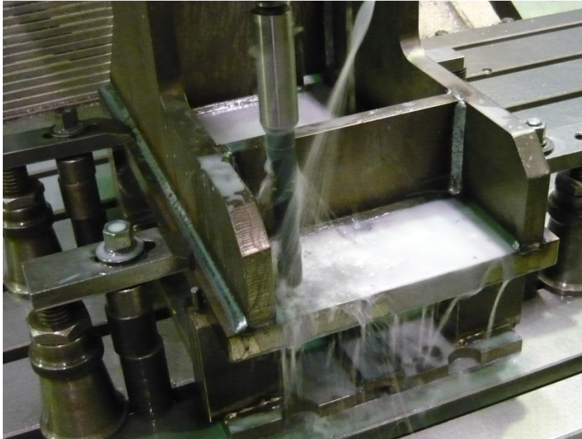
Obrázek 4.5- šroubový vrták \varnothing 22,5 mm byl použit k vyvrtání díry pro závit M24 a k předvrtání děr \varnothing 34 mm
