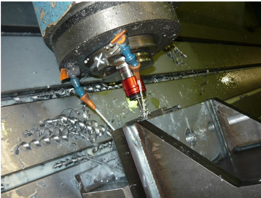
Obrázek 4.11- závitník M5 byl použit pro zhotovení závitu
