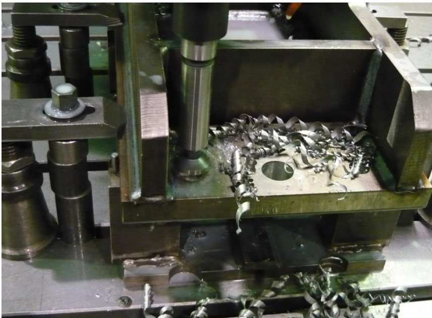
Obrázek 4.8- kuželový záhlubník \varnothing 40 mm byl použit ke sražení hran pod závit
