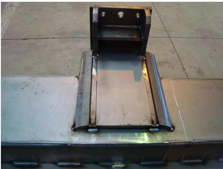
Obrázek 5.11- kompletní zavaření „boty“
