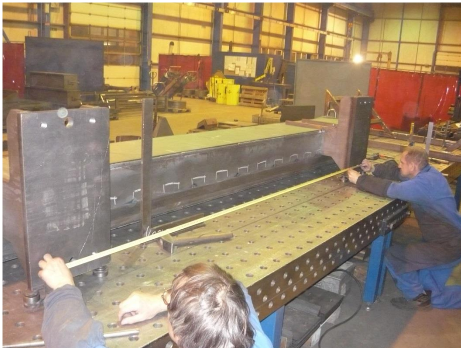
Obrázek 5.13- měření vzdálenosti 1500 mm
