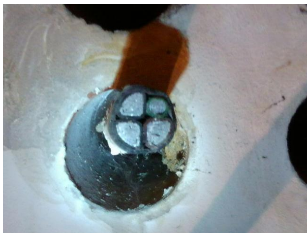
Obr. 3: Fotografie řezu kabelu AYKY
