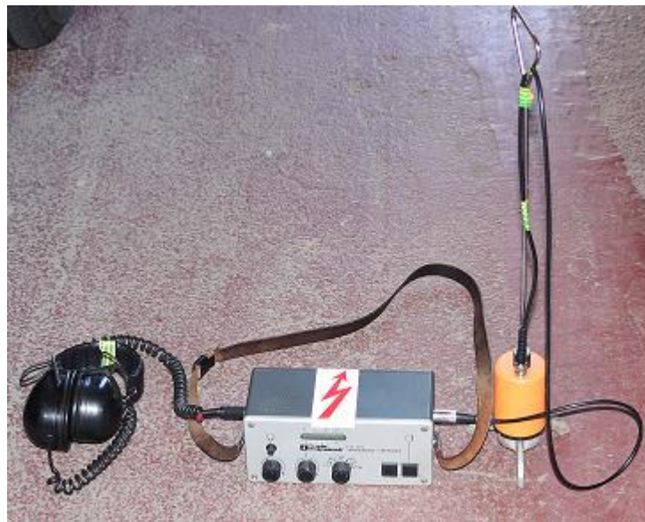
Obr. 11: Fotografie přijímače rázového generátoru se sluchátky a půdního mikrofonu
