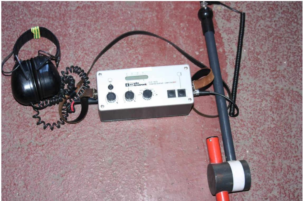
Obr. 19: Fotografie univerzálního přijímače s induktivním senzorem
