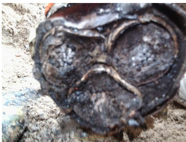
Obr. 1: Fotografie řezu kabelu ANKTOYPV
