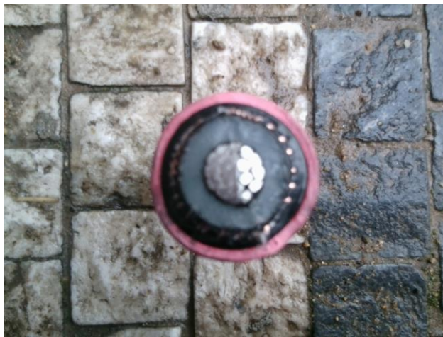
Obr. 2: Fotografie řezu kabelu AXEKVCEY
