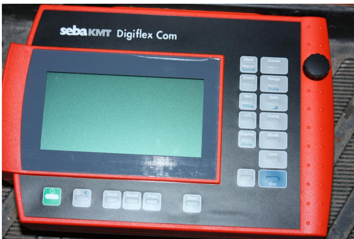
Obr. 20: Fotografie přenosného impulsního zaměřovače
