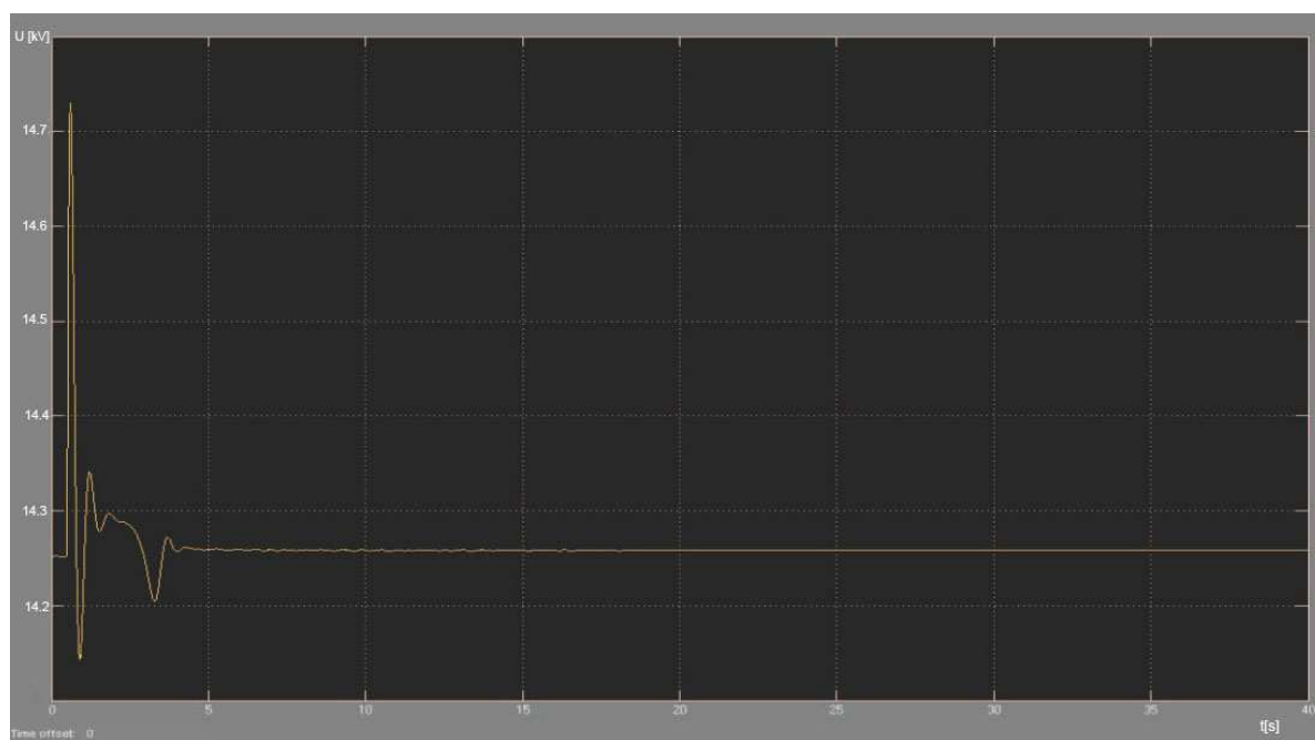
Obr.4.4.9 Výsledný průběh simulovaného napětí generátoru
