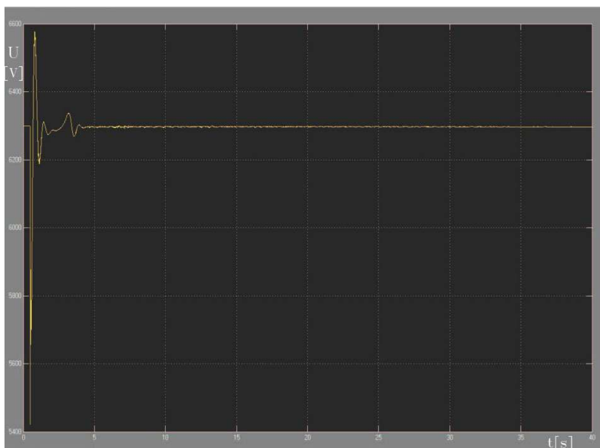
Obr.4.4.10 Výsledný průběh simulovaného napětí při najždění spotřebiče VS
