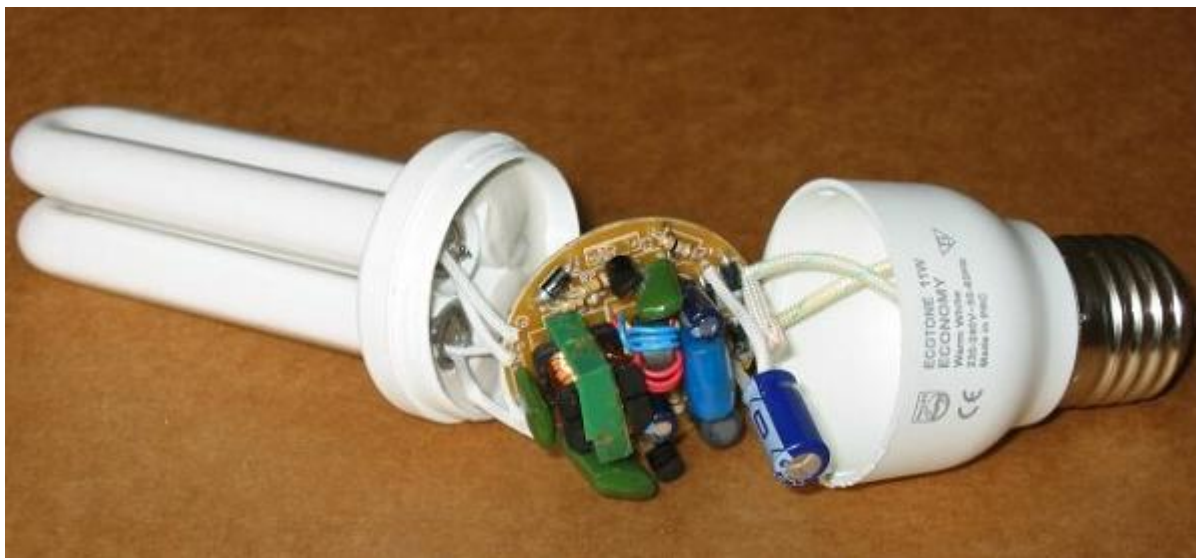
(Obr. 8 Vnitřní uspořádání zářivky[6])
