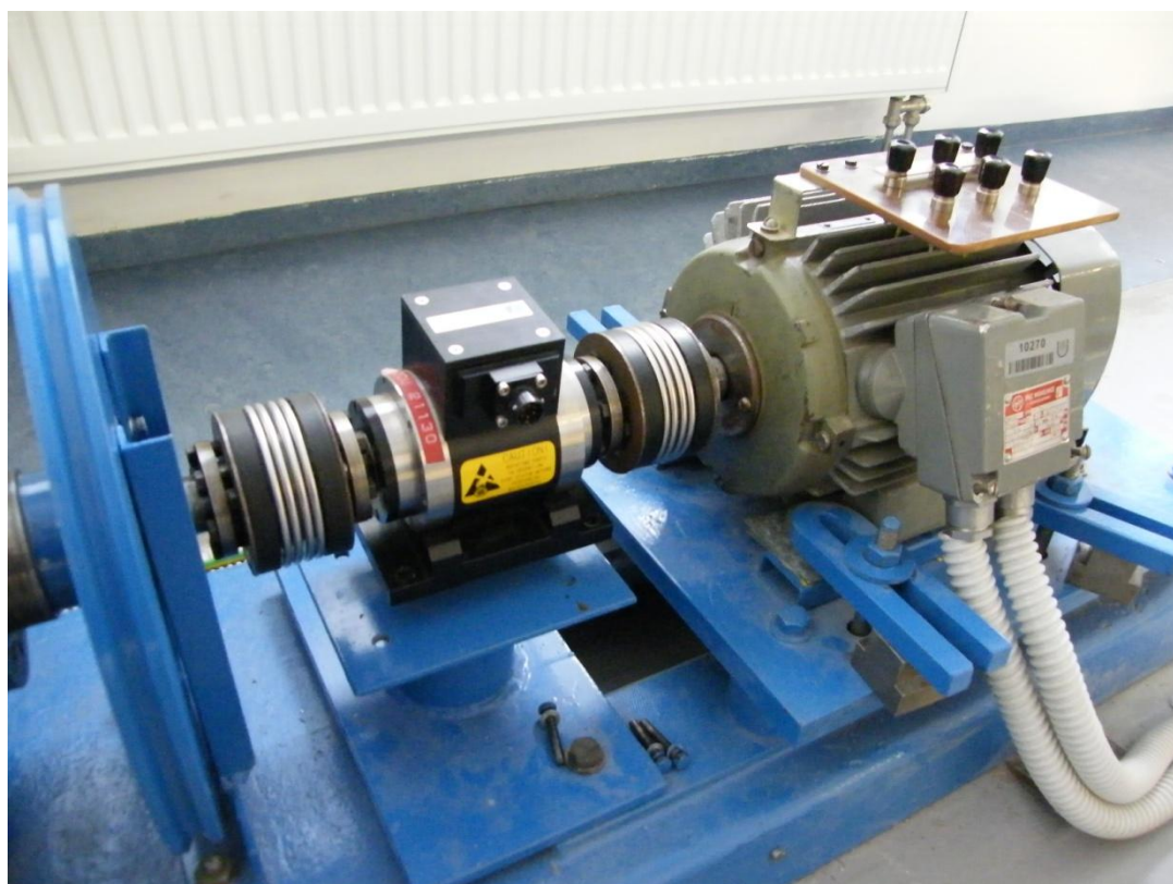
Příloha 7: Měřený asynchronní motor (vpravo) - na hřídeli je připevněn torzní dynamometr (vlevo)
