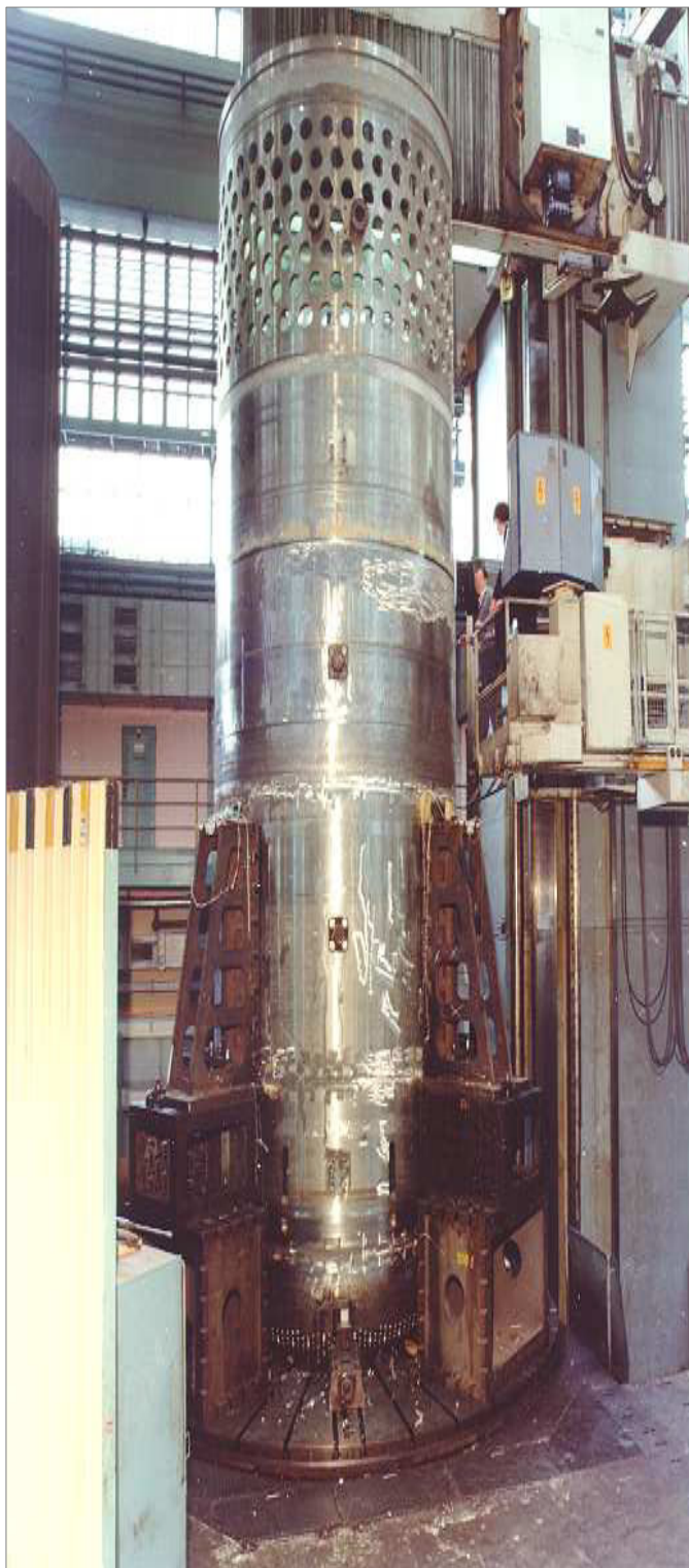
Obr. č. 11: Vnitřní část reaktoru
